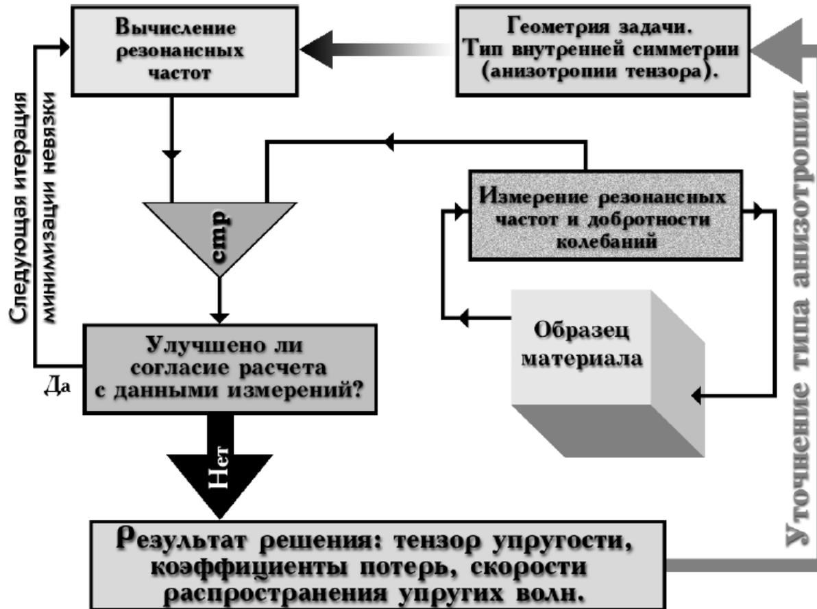
В основе метода резонансной акустической спектроскопии лежит связь между спектром собственных частот образца и его механическими параметрами
