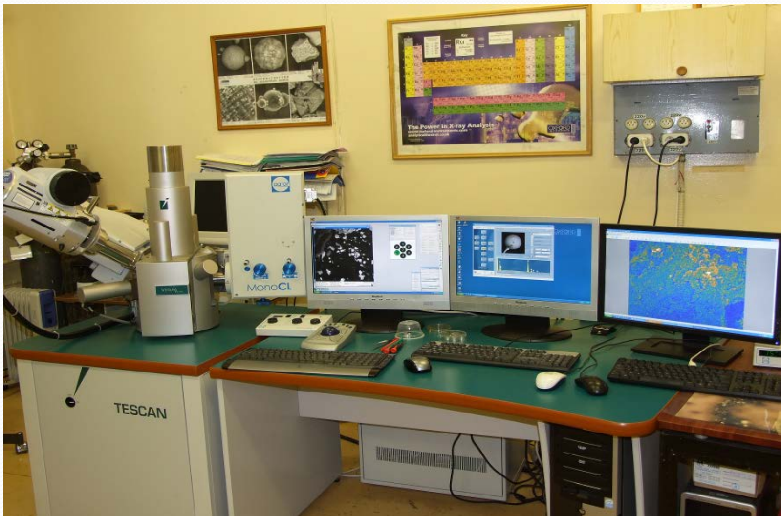
Микрозонд «Тескан Вега II» с энергодисперсионным и волновым спектрометрами (ИФЗ РАН)
