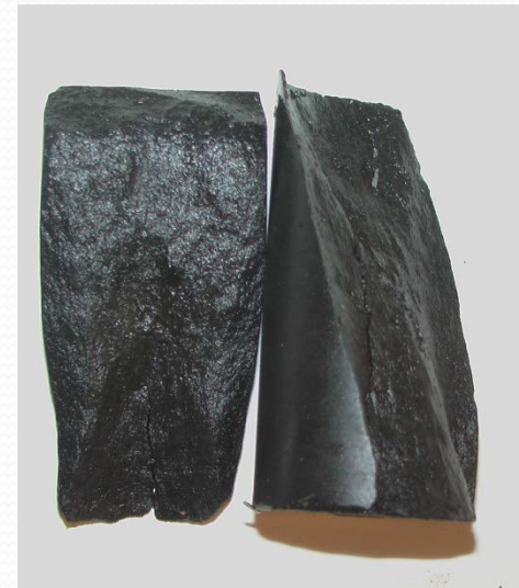
Образец базеновской свиты после испытаний в прессе
